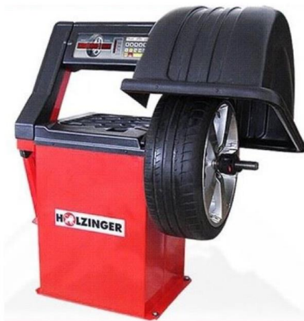
FIGURE 1 – Machine de test d'équilibrage des pneumatiques : un capteur détecte les déformations de l'axe de rotation causées par le déséquilibre et indique la position des masselottes à ajouter.
