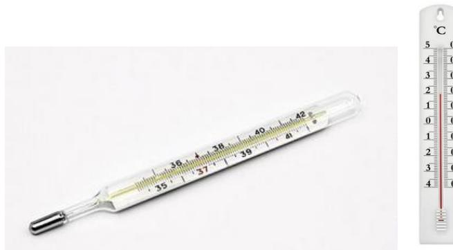
Ci-dessus à gauche, un thermomètre à mercure médical gradué en degrés Celsius, à droite un thermomètre à alcool pour particulier, le mercure étant une substance toxique par ingestion, contact et inhalation.
