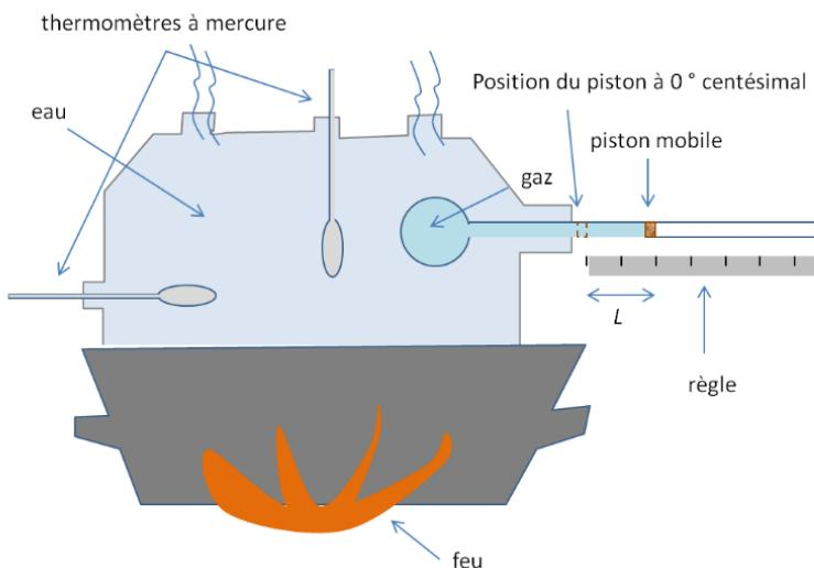
Si on note  $V_0$  le volume occupé par un gaz comme de l'air à pression atmosphérique normale et à une température de 0 degré centésimal, alors le volume occupé à une température centésimale  $\theta$  sur une plage de températures usuelles, suit une loi expérimentale de la forme :
