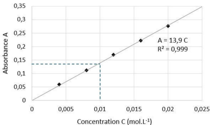
On peut alors utiliser cette courbe pour mesurer par exemple la concentration inconnue d'une solution de sulfate de cuivre. Si on mesure par exemple avec le spectromètre une absorbance de 0,135, on la porte sur l'axe des ordonnées et on lit l'antécédent sur le graphique qui est ici 0,01 mol L⁻¹.
