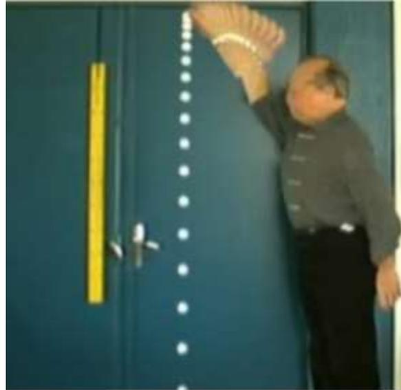
Dans cette l'expérience, l'expérimentateur a suspendu une règle jaune qui mesure 1,02 m et que l'on voit sur le cliché ainsi que les positions de la balle de golf tous les  $\frac{1}{30}$  ème de seconde.
