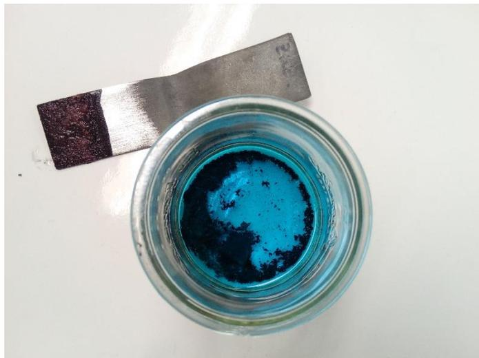
En vidant le pot de la solution (on peut également procéder à un filtrage du dépôt) on constate que le dépôt initialement de couleur noire prend la teinte du cuivre. D'ailleurs une fois bien sec, on observe un plaquage de cuivre sur le fond du pot comme le montrent les photos ci-dessous :
