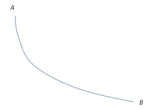
Considérons une section infinitésimale  $dS_A$  perpendiculaire au vecteur vitesse  $\vec{v}_A$  de la particule d'eau au point A. Les points de cette section définissent une section  $dS_B$  en B perpendiculaire au vecteur vitesse  $\vec{v}_B$  de la particule d'eau au point B.
