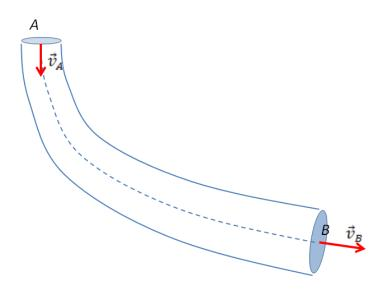
Les particules d'eau se trouvant à un instant t dans la section  $dS_A$  se retrouvent à un instant ultérieur dans la section  $dS_B$ . Leurs trajectoires forment un tube de courant.
