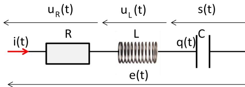
Nous allons nous intéresser à la tension  $s(t)$  aux bornes du condensateur donnée par le circuit et appelée **sortie**, si on lui applique une tension  $e(t)$  appelée **entrée**, très forte sur un très court laps de temps.
