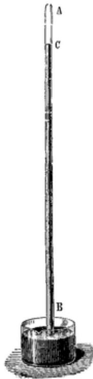
Le principe est simple. Torricelli, que vous voyez sur la photo ci-dessous, a rempli à ras bord un tube de verre de **mercure**, qui rappelons le est un métal argenté à l'état liquide dans les conditions ambiantes (on l'appelait pour cela le **vif argent**), et en l'obturant de son doigt, il l'a plongé dans un récipient rempli également de mercure comme dans la figure ci-dessus.
