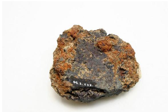
La loupe de fer obtenue (encore appelée éponge, voir photo ci dessous) n'est pas du fer métallique pur. Il reste encore des impuretés (à hauteur de 5 %, qui vont être éliminées dans un travail de raffinage constitué d'un chauffage dans du charbon de bois associé à un martelage, qui a également pour effet de rendre le matériau homogène.
