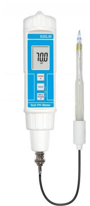
Le principe du pH mètre est d'exploiter la différence de potentiel apparaissant entre les solutions interne et externe d'une électrode de verre, qui dépend comme nous l'avons vu de la différence de pH des solutions de part et d'autre des parois.
