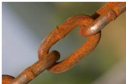
La rouille est un phénomène plus complexe qu'il n'y paraît. Un morceau de métal mis dans un air sec ne rouille pas, de même que dans de l'eau exempte de dioxygène. Si un morceau de fer baignant dans une flaque rouille rapidement, c'est qu'il y a du dioxygène dissous dans la flaque. D'ailleurs comment feraient les poissons pour respirer s'il n'y avait pas d'oxygène dissous dans les rivières, les mers et les océans.
