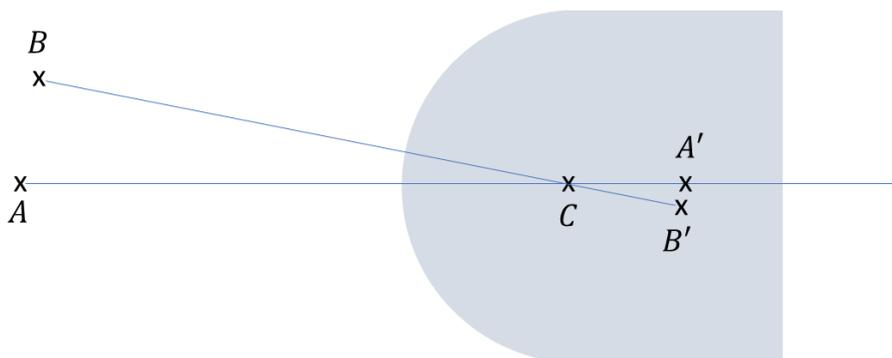
Dans le cas où  $B$  est proche du point  $A$ , il peut être considéré comme étant dans le plan tangent à la sphère en  $A$ , idem pour  $B'$  dans le plan tangent à la sphère en  $A'$ . La situation peut alors être schématisée de la façon suivante :
