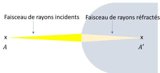
**2<sup>ème</sup> situation** : Les rayons réfractés divergent. Seules leurs prolongations ont une intersection en  $A'$ . Un écran placé en ce dernier point ne permettra pas de faire apparaître une petite tache lumineuse. On dit que l'image est virtuelle.
