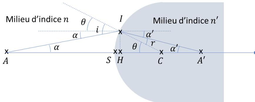
Soit en effet un rayon incident émis en un point  $A$  se réfractant en un point  $I$  de l'interface sphérique et intersectant l'axe du cône en un point  $A'$ . Nous avons les relations angulaires :
