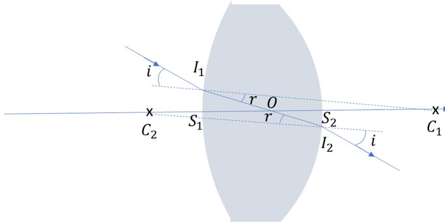
Notons  $C_1$  le centre du premier dioptre sphérique,  $C_2$  celui du second et convenons des notations suivantes pour les rayons de courbure algébriques :
