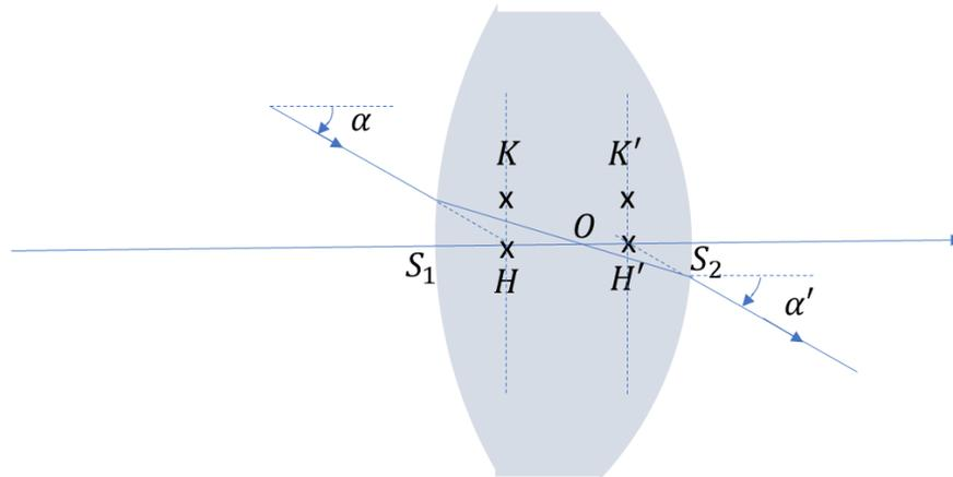
Considérons un rayon incident associé au point objet  $H$  (virtuel sur la figure). Il ressort de la lentille sous forme d'un rayon émergent associé au point image  $H'$  (virtuel sur la figure). D'après la relation de Lagrange Helmholtz, en notant  $n$  l'indice de réfraction de la lentille et  $n_0$  celui du milieu dans lequel elle baigne, si  $K$  est un point situé dans le plan passant par  $H$  orthogonal à l'axe optique et  $K'$  son image par la lentille, alors :
