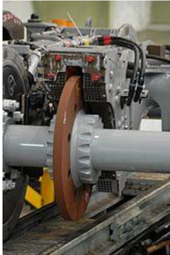
Freinage par courant de Foucault- Shinkansen source wikipédia
