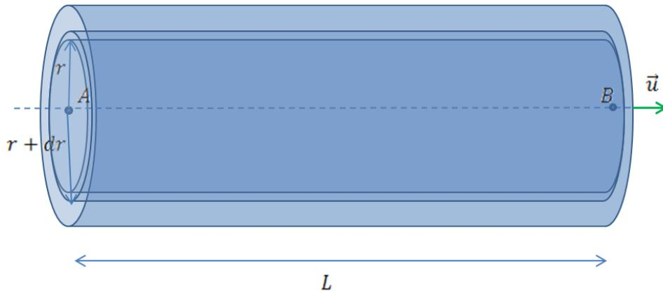
Considérons un cylindre annulaire d'axe  $(A, \vec{u})$  et de rayon intérieur  $r$  et de rayon extérieur  $r + dr$  contenu dans la conduite,  $dr$  étant infinitésimal. Faisons un bilan de variation d'énergie totale du fluide situé dans ce cylindre, c'est-à-dire interne plus mécanique macroscopique entre deux instants  $t$  et  $t + dt$  infiniment proches.
