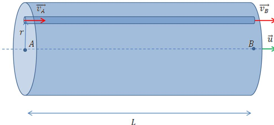
Considérons un tube de courant de section d'entrée infinitésimale  $dS_A$  par laquelle le fluide entre avec un vecteur-vitesse  $\vec{v}_A = v_A \vec{u}$  pour ressortir à une distance  $L = AB$  par une section  $dS_B$  avec un vecteur-vitesse  $\vec{v}_B = v_B \vec{u}$ . La conservation du débit  $d^2q$  à travers cette section se traduit par l'équation :
