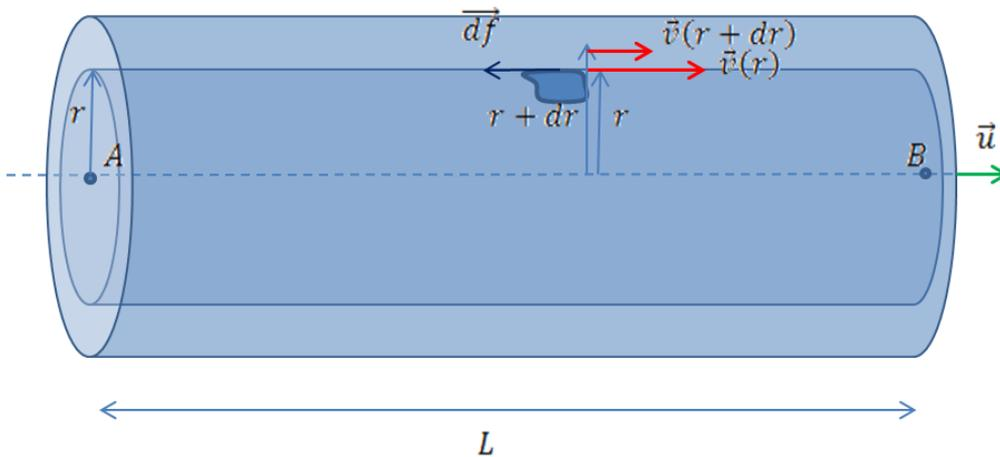
Considérons une petite surface élémentaire  $d^2S$  sur un cylindre de même axe  $(A, \vec{u})$  que la conduite et de rayon  $r$  strictement inférieur au rayon  $R$  de la conduite. Le milieu extérieur à ce cylindre exerce sur ce dernier au niveau de cette surface de contact une force tangentielle de frottement due au différentiel de vitesse entre filets de fluide voisins, de la forme :
