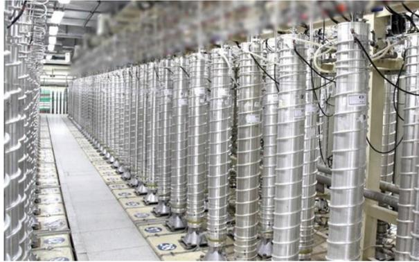
Batterie de centrifugeuses en séries
