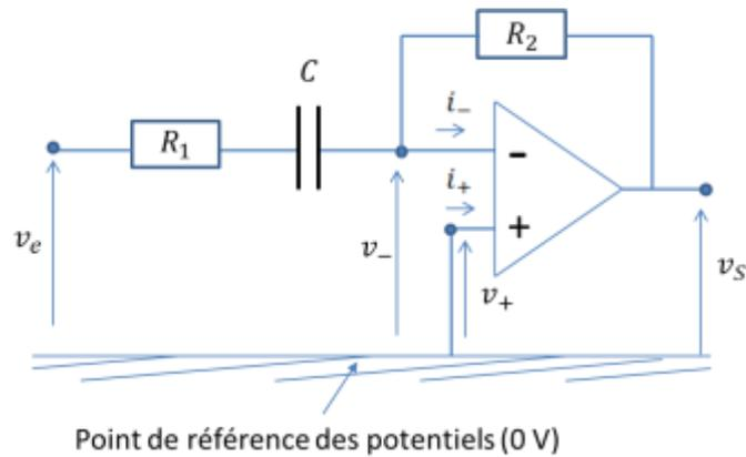
On rappelle les caractéristiques d'un amplificateur opérationnel idéal fonctionnant dans son domaine linéaire : les courants entrant sur les entrées inverseuses (-) et non inverseuse (+) sont négligeables devant les courants traversant les résistors. On peut alors faire apparaître les différents dipôles sur un pont diviseur de tension, en considérant les grandeurs complexes pour une tension d'entrée  $v_e$  de la forme  $v_e(t) = \hat{V}_e \cos(\omega t)$  :
