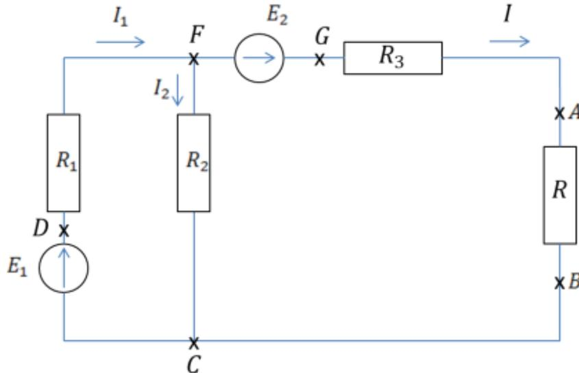
1) Déterminer l'intensité qui traverse le résistor de résistance  $R$  en utilisant la méthode systématique (loi des nœuds, loi des mailles,...) et en prenant les valeurs suivantes (3 pts) :
