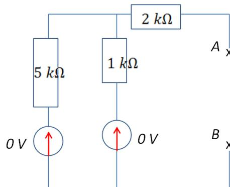
La résistance équivalente est obtenue par mise en série d'une résistance de  $2\text{ k}\Omega$  d'un dipôle formé d'une résistance de  $5\text{ k}\Omega$  en parallèle avec une résistance de  $1\text{ k}\Omega$ , soit :
