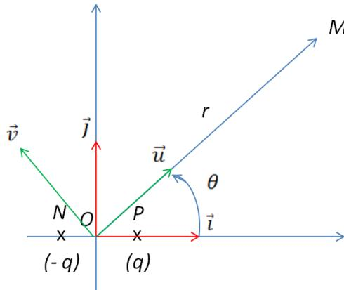
On considère un dipôle électrostatique dont l'image est une charge négative  $-q$  placée en un point  $N$  de l'espace et une charge positive  $q$  placée en un point  $P$ . On se place dans un plan contenant le dipôle et on munit le plan d'un repère orthonormé  $(O, \vec{i}, \vec{j})$  comme défini sur la figure. On rappelle que le potentiel électrostatique associé au champ lointain s'exprime en un point  $M$  en coordonnées polaires par :
