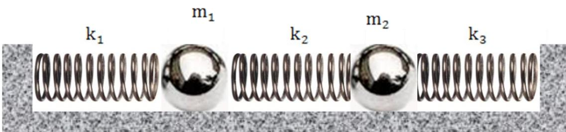
Ecartons les deux masses de leur position d'équilibre et laissons le système osciller librement. L'origine des temps étant prise au moment du lâcher (mise en marche du chronomètre à cet instant), les positions des masses sont connues, à un instant  $t$ , par deux abscisses  $x_1(t)$  et  $x_2(t)$ , l'axe des abscisses étant orienté de la gauche vers la droite.
