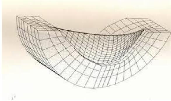
Si le système est de taille  $n$ , il en résulte par résolution analogue à ce qui a été fait ci-dessus, une mise en évidence que le vecteur  $X$  des degrés de liberté est une combinaison linéaire de  $n$  vecteurs propres, dont les coefficients sont des fonctions sinusoïdales (en l'absence d'amortissement toutefois dans le système, sinon il faut rajouter devant ces fonctions une fonction exponentielle d'amortissement).
