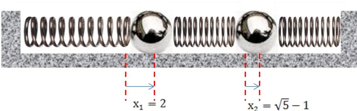
$P_1$  représente l'état qu'aurait le système s'il n'oscillait que sur sa première composante modale (soit  $y_2(t) = 0$ ), pour une amplitude  $A_1$  égale à 1 et un sinus valant 1 dans l'expression de  $y_1(t)$ . L'oscillation associée à ce mode se fait à la fréquence dite propre de :
