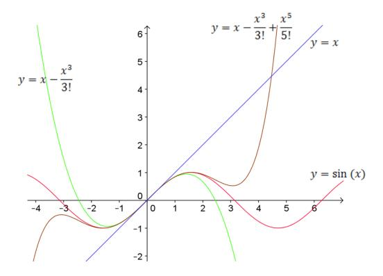
On constate que plus l'ordre du polynôme est élevé, plus la courbe de ce dernier semble se confondre avec celle de la fonction sinus sur un intervalle de plus en plus grand centré sur 0. Ce point va être confirmé par le théorème de Taylor Lagrange.
