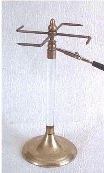
Principe : Les pointes chargées par une machine électrostatique produisent dans leur voisinage de forts champs électriques capables d'ioniser les molécules d'air qui les environnent. Si les pointes sont chargées positivement par exemple, les ions positifs ainsi créés dans l'air et les pointes se repoussent par interaction électrostatique, ce qui met ces dernières en mouvement et produit la rotation du dispositif.
