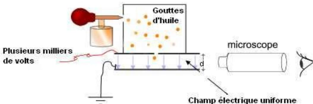
Un pulvérisateur produit un nuage de gouttelettes d'huiles, qui par la friction opérée par leur passage à travers la buse de sortie, se chargent électriquement, avant de tomber dans la chambre supérieure d'un dispositif. Certaines gouttes parviennent à passer au travers d'un orifice pratiqué dans l'armature supérieure d'un condensateur plan et retombent entre les
